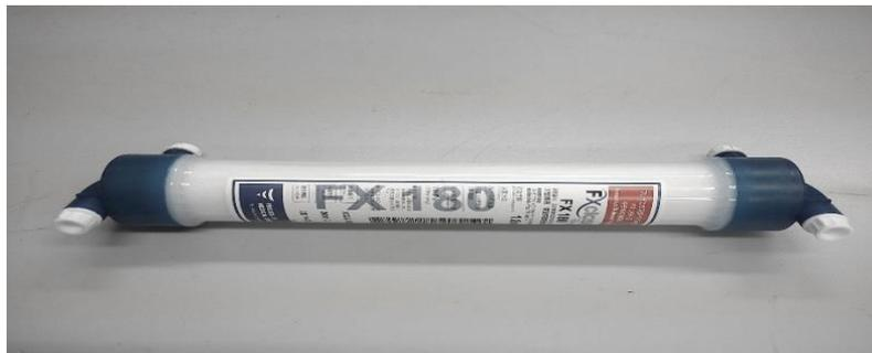
図 5.10 実験に用いた PS 膜ダイアライザ
