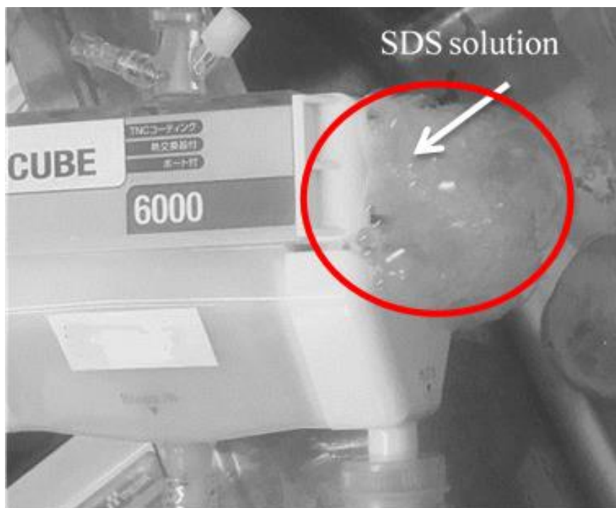
図 6.8 人工肺ガス出口側からの SDS 溶液の漏れ写真
